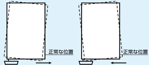
③のネジをゆるめ、④のネジを締付ける。
