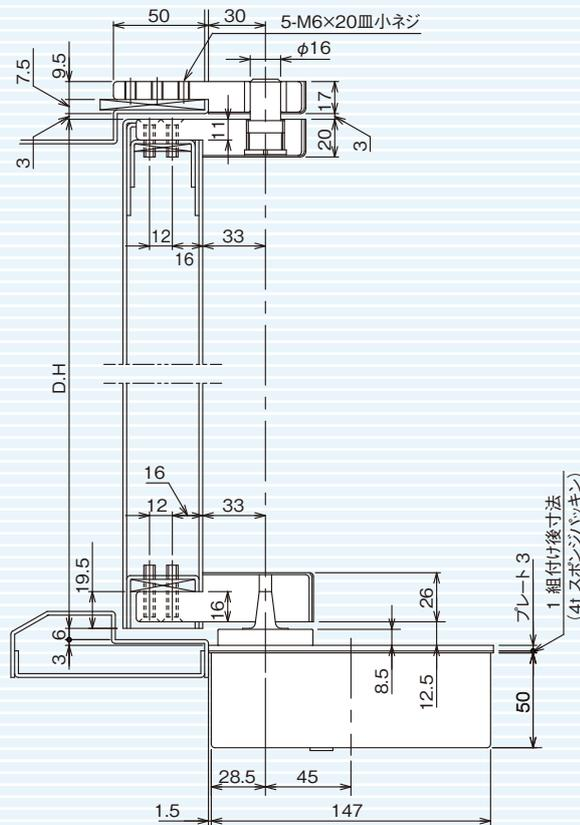
一方開き用ヒンジには、押し代がついています。扉を閉めたときに、反対側へ5° 行き過ぎて停止しますので、必ず戸当たりを設置して下さい。
