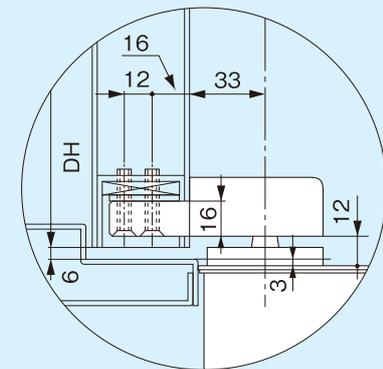
一方開き用ヒンジには押し代がついています。扉を閉めた時に、反対側へ5°行き過ぎて停止しますので、必ず戸当りを設置して下さい。
